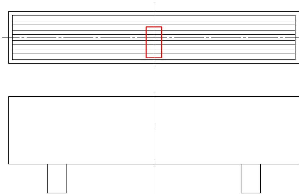
Тепловой адаптер необходимо уложить в центральную часть таким образом, чтобы крепежные отверстия попадали на ребра конвектора.
