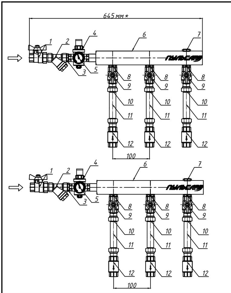
Узел коллекторный для водоснабжения "Пульсар" на 3 отвода :
