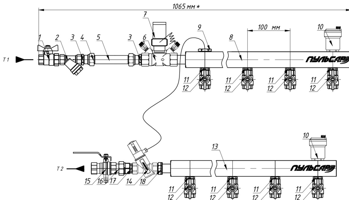
Узел коллекторный для отопления квартирный «Пульсар» на 5 отводов:
