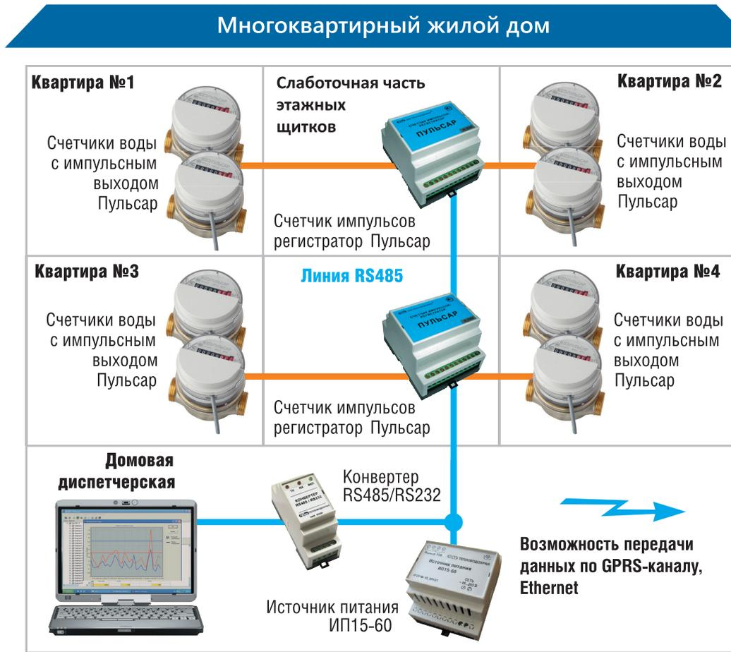
Рис. 1. Сбор данных счетчиков с импульсным выходом по проводам. Состав автоматизированной системы: счетчики воды, газа, электроэнергии, тепла с импульсным выходом; счетчики импульсов-регистраторы «Пульсар»; конвертер RS-485/RS-232; источники питания ИП 15-60 (1 ИП-15-60 на 40 счетчиков импульсов – регистраторов)
