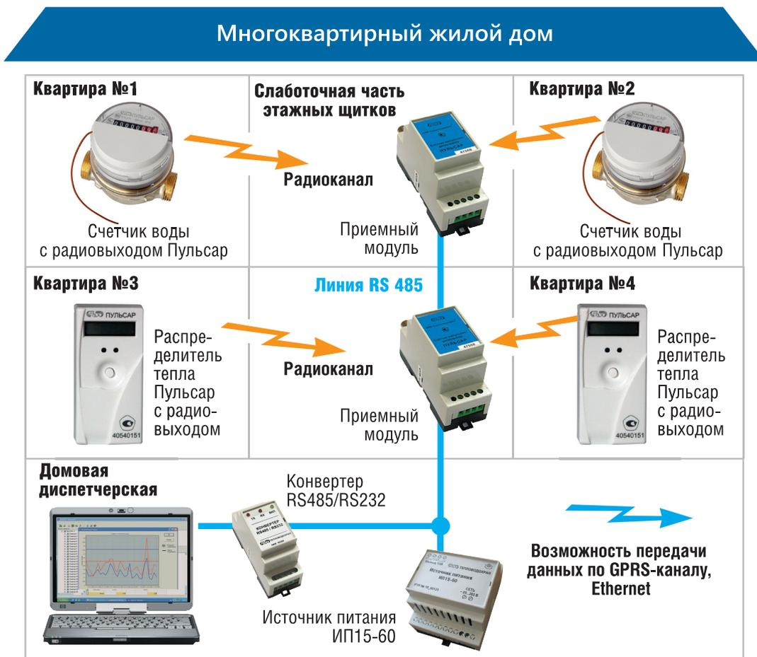
Рис. 2. Сбор данных счетчиков и распределителей «Пульсар» по радиоканалу. Состав автоматизированной системы: счетчики воды «Пульсар» с радиовыходом; распределители тепла «Пульсар» с радиовыходом; приемный модуль; конвертер RS-485/RS-232 либо RS-485/USB; источники питания ИП 15-60
